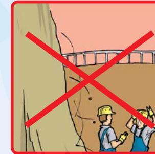
**ESPAÑOL** Las paredes de la excavación deben estar protegidas para eliminar irregularidades y evitar desprendimientos de bloques de tierra o masas emergentes.
