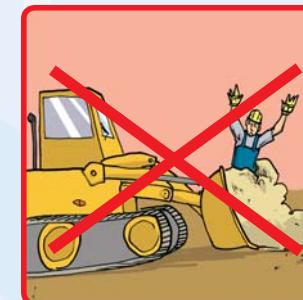
**ESPAÑOL** En las excavaciones con medios mecánicos no permanezca en el campo de acción del vehículo ni en el borde de la excavación.
